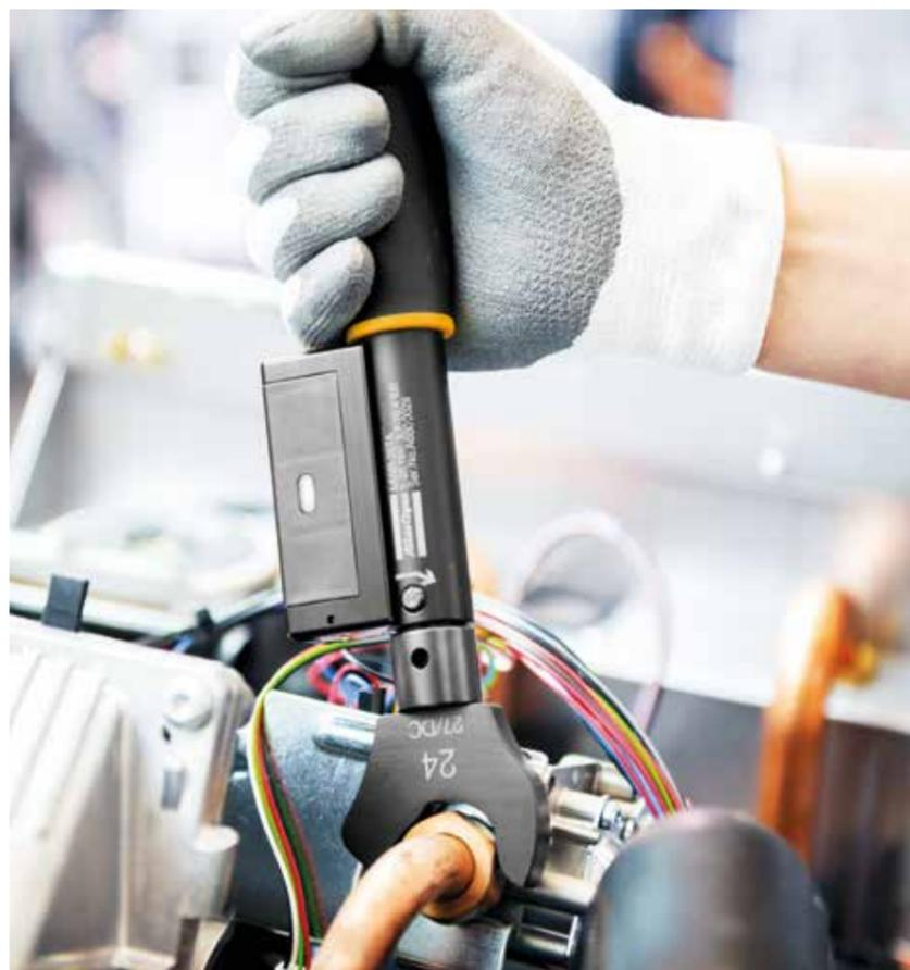
zeigt den Status oder mögliche Fehler beim Schraubvorgang an. Der Focus-Controller steuert den Prozess und erfasst sämtliche Daten mit allen Ergebnissen in Echtzeit, um vollständige Rückverfolgbarkeit zu gewährleisten. Die Manager können alles über ToolsNet überwachen.
