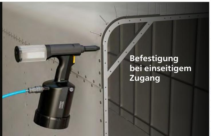
Befestigung bei einseitigem Zugang
